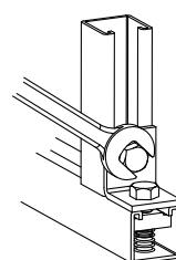
**1** Las tuercas unicanal se insertan fácilmente en cualquier punto de la ranura longitudinal. Solo presione y gire para tratar tuerca en borde 180°.
