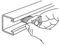
**1** Las tuercas unicanal se insertan fácilmente en cualquier punto de la ranura longitudinal. Solo presione y gire para trabar tuerca en borde 180°.
