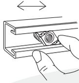
**2** El resorte mantiene las tuercas pegadas al borde 180° permitiendo simultáneamente el desplazamiento para lograr un ajuste preciso.
