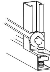
**4** Coloque y fije segundo riel para obtener una conexión rígida. Al apretar el tornillo la tuerca se encaja en el borde 180° creando una excelente conexión mecánica.
