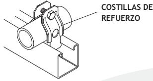
\* Ajuste perfecto con el menor diámetro exterior de los conduit pared delgada C.20. Perforación de identificación evita confusiones.
